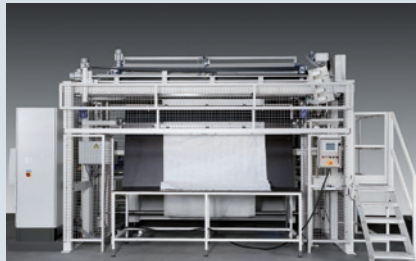
KL 245 - Umsäumanlage (Überwendlich) für die Fertigung von Stepdecken
