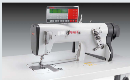
PFAFF 5483-H-814/01-6/10 – Zweinadel-Doppelkettenstichmaschine mit Untertransport, Tandem-Gelenkfuß und Rückwärtsstich-Einrichtung zum Schließen der Gesäßnaht (~ 1.000 Gesäßnähte in 480')
