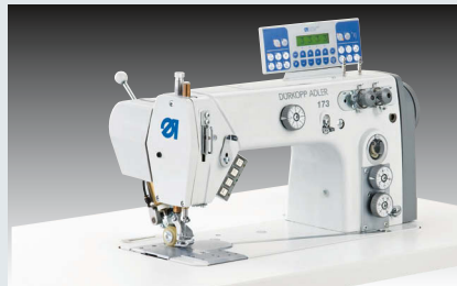
Dürkopp Adler 173-141621 – Einnadel-Doppelkettenstichmaschine mit Unter- und Walzen-Obertransport und optional mit Führungsapparat für Bund und Bundfutter (~ 1.200 Bunde in 480')
