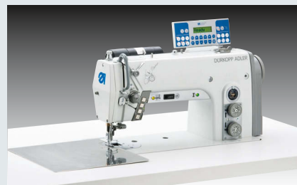
Dürkopp Adler 272-740642-01 (E113) – Doppelsteppstichmaschine mit Nadeltransport zum Vornähen und Beschneiden von Kleinteilen durch manuelle Schablonenführung (~ 1.400 Patten in 480’)
