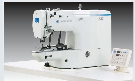
Dürkopp Adler 532-211-01 – CNC gesteuerter Doppelstepstich-Knopfnähautomat, optionaler Bausatz für mittelschwere bis schwere Anwendungen (~ 950 – 1.050 Hosen, bei 3 Knöpfen, in 480')
