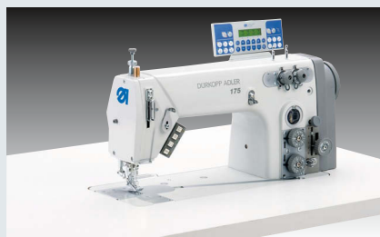
Dürkopp Adler 175-141621 – Zweinadel-Doppelkettenstichmaschine mit differenzierbarem Obertransport für Mehrweite im Reißverschluss, Bandabzugsggerät, optional (~ 4.000 Schlitzleisten in 480’)
