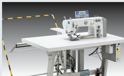
Beisler 1270-5 – Gestalteter Arbeitsplatz mit Puller, pneumatischem Kantenanschlag und Stapler zum Schließen der Seiten- und Schrittnähte, Doppelkettenstich (~ 350 – 400 Hosen, 4 Nähte, in 480')
