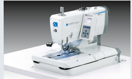
Dürkopp Adler 581-151 – CNC gesteuerter Augenknopflochautomat mit manuellem Fadenabschneider und Gimpe (~ 800 Hosen (bei 3 Knopflöchern) in 480')
