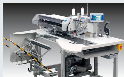
Dürkopp Adler 745-35-10 S – Nähanlage für gerade Paspel- und Leistentaschen mit und ohne Patte, mit manueller Zuführung (~ 1.600 – 2.000 Taschen in 480')
