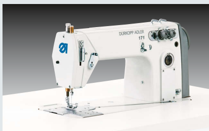
Dürkopp Adler 171-131610 – Zweinadel-Doppelkettenstichmaschine mit Untertransport und Tandem-Gelenkfuß zum Schließen der Gesäßnaht (~ 700 Gesäßnähte in 480')
