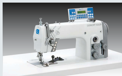
Dürkopp Adler 275-140342-01 (550-2-1) – Doppelsteppstichmaschine mit differenzierbarem Obertransport + Faltparat zum Ankappen der linken Schlitzleiste (~ 500 – 600 Hosen, r/l Schlitzleiste, in 480')
