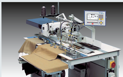
Beisler 2211-5 – Nähanlage zum Umbiegen, Vornähen und Einschneiden von Flügelertaschen in hoher Qualität, Doppelsteppstich (~ 800 Hosen, = 1.600 Tascheneingriffe, in 480')
