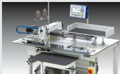
Beisler 2171-5 – Nähanlage für Seitennaht- und Flügelertaschen in hoher Qualität nähen und einschneiden, Doppelsteppstich (~ 1.000 Hosen, = 2.000 Tascheneingriffe, in 480')
