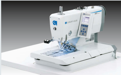
Dürkopp Adler 581-112 – CNC gesteuerter Augenknopflochautomat mit Kurzfadenschneider ohne Gimpe für klassische Hosen (~ 800 Hosen, bei 3 Knopflöchern in 480')
