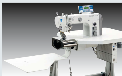
Dürkopp Adler 550-5-5-2 – Gestalteter Arbeitsplatz mit Doppelstepstichmaschine, Puller und Nadeltransport zum Absteppen des Bundes im Nahtschatten oder auf den Bund (~550 Hosen in 480')
