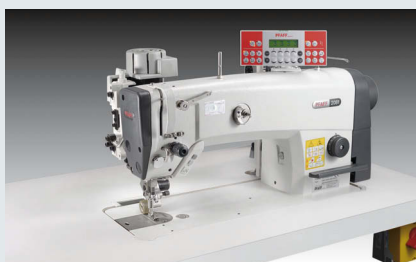
PFAFF 2081-748/02 – Einnadel-Doppelstepstich Schnellnäher mit Unter- und Nadeltransport und Puller (~ 500 Hosen in 480')
