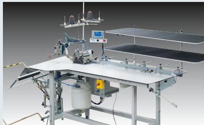
Beisler 1281-5-1 – Nähanlage zum automatischen Schließen der Seiten- und Schrittnähte wahlweise mit Doppelkettenstich- oder 4-/5-fädige Safety-Naht (~ 430 – 450 Hosen, 4 Nähte, in 480')
