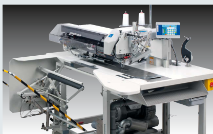
Dürkopp Adler 745-35-10 A – Nähanlage für gerade oder optional schräge Paspel- und Leistentaschen mit und ohne Patte, mit manueller Zuführung (~ 1.600 – 2.000 Taschen in 480')
