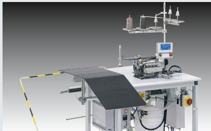
Beisler 1280-5-1 – Nähanlage zum semi-automatischen Schließen der Seiten- und Schrittnähte wahlweise mit Doppelkettenstich- oder Safety-Naht, Taschenbeutel verschneiden möglich (~ 380 – 400 Hosen, 4 Nähte, in 480')
