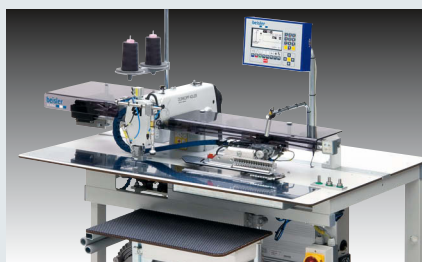
Beisler 1931-5 – Nähanlage zum automatischen Absteppen der linken Schlitzleiste mit Einfach- oder paralleler Doppelnaht (~ 1.600 gebügelte Schlitzleisten, Doppelnaht, in 480')
