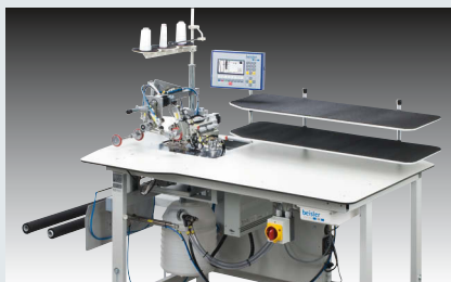
Beisler 1265-5 – Einkopf-Umstechanlage mit differenzierbarem Ober- und Untertransport für Hosen mit /ohne Kniefutter, geeignet für Stretch-Materialien (~ 450 Hosen, 8 Nähte, mit Kniefutter in 480')
