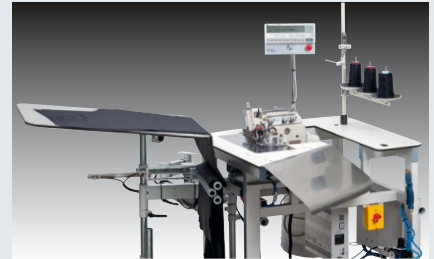
Beisler 1260-5 – Einkopf-Umstechanlage mit Untertransport für Gesäß-, Schlitznähte und Kleinteile mit ergonomischer Arbeitsplatzgestaltung (~ 3.300 – 3500 Hosen, 2 Nähte, in 480')
