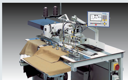
Beisler 2211-5 – Nähanlage zum Umbiegen, Vornähen und Einschneiden der linken Schlitzleiste, optional zum Annähen der rechte Schlitzleiste, Doppelsteppstich (~ 1.000 Hosen, r/l Schlitzleiste nähen in 480')
