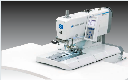
Dürkopp Adler 581-312 – CNC gesteuerter Augenknopflochautomat mit Multiflex-Schneidsystem und Kurzfadenschneider ohne Gimpe für klassische Hosen (~ 800 Hosen, bei 3 Knopflöchern in 480')
