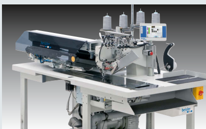
Beisler 100-69 – Nähanlage für gerade oder optional schräge Paspel-, Patten- und Leistentaschen mit manueller Zuführung (~ 1.600 – 2.000 Taschen in 480')
