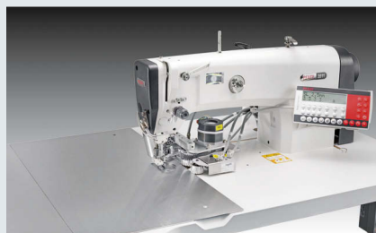
PFAFF 3511 – Doppelsteppstich-Näautomat zum Vornähen und Beschneiden von Kleinteilen durch Schablonensteuerung (~ 1.600 Patten in 480’)
