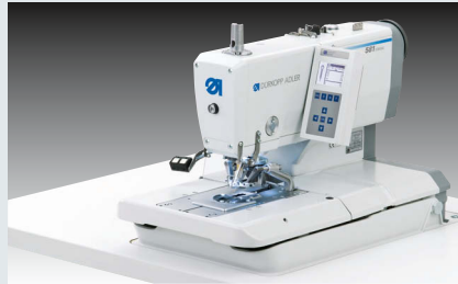
Dürkopp Adler 581-141 – CNC gesteuerter Augenknopflochautomat mit Kurzfadenschneider und Gimpe für Freizeituhosen (~ 800 Hosen, bei 3 Knopflöchern, in 480')
