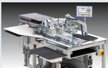
Beisler 2112-5 – Nähanlage zum Umbiegen, Vornähen und Einschneiden der linken Schlitzleiste, optional zum Annähen der rechte Schlitzleiste, Doppelsteppstich (~ 1.000 Hosen, r/l Schlitzleiste nähen in 480')
