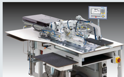
Beisler 2112-5 – Nähanlage zum Umbiegen, Vornähen und Einschneiden von Flügelertaschen, Taschenbesetzen/Schlitzleisten aufnähen, Doppelsteppstich (~ 800 Hosen, = 1.600 Tascheneingriffe, in 480')
