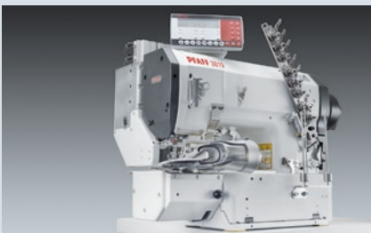
PFAFF 3819 - Automatischer Näharbeitsplatz zum Annähen des Hosenbundes. Arbeitsmethode: Bundmaterial von der Rolle
