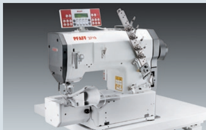
PFAFF 3719 - Näharbeitsplatz zum Annähen des Hosenbundes. Arbeitsmethode: abgelängtes Bundmaterial
