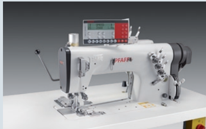
PFAFF 5489-H - Doppelkettenstich-Spezialschnellnähler mit Differential-Untertransport für Kappnähte
