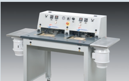
Dürkopp Adler 906 TUP-BRI - Taschenumbuggpresse optional mit Kühlstation für Materialien mit hohem Elastananteil
