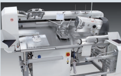
PFAFF 3588 - Programmierbarer Taschenautomat für das Verarbeiten von nicht-vorgebuggten Taschen
