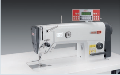
PFAFF 2081 - Einnadel-Schnellnäher mit Unter- und Nadeltransport
